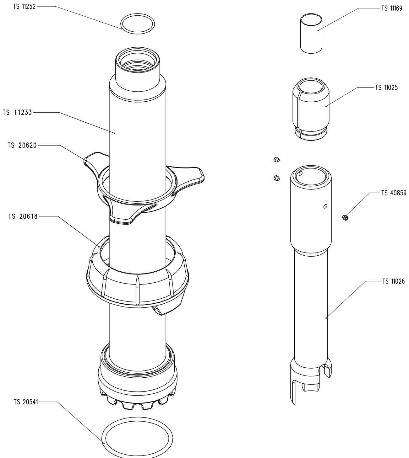
**Рисунок 12-7: защитная трубка SS2-Q2 с нагрузкой TS 10182, запчасти**
