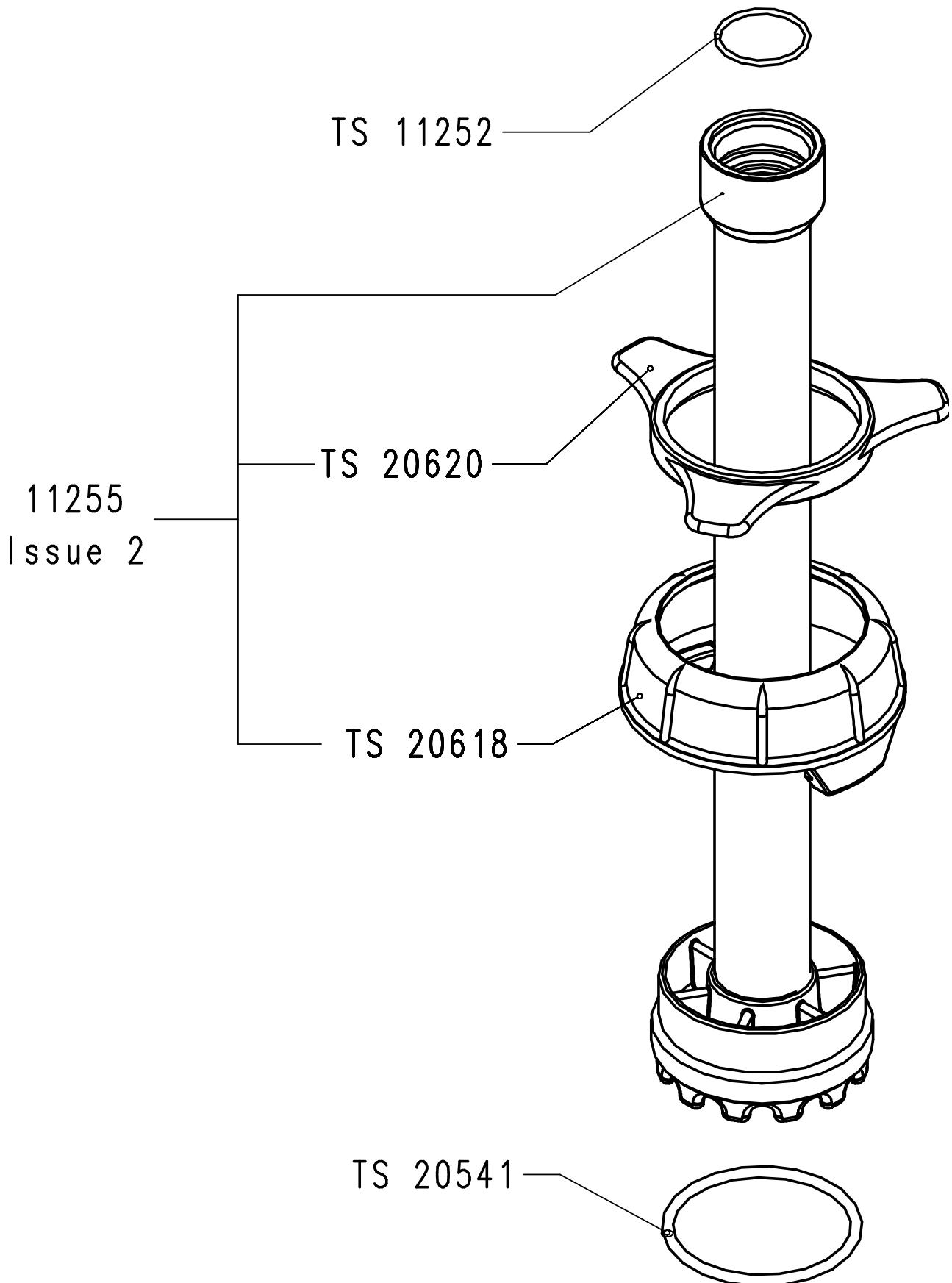
Рисунок 12-6: защитная трубка SS1-Q2 TS 10183, запчасти
