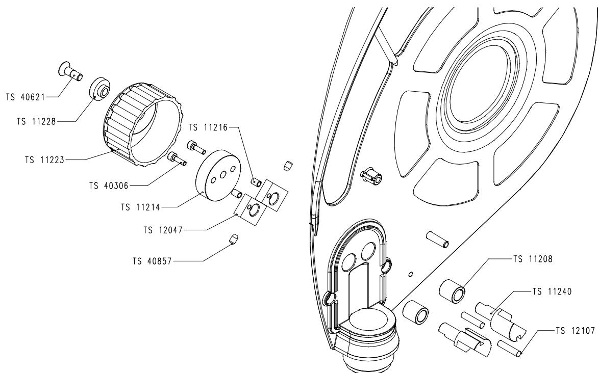
**Рисунок 12-8: устройство очистки ленты, запчасти**
